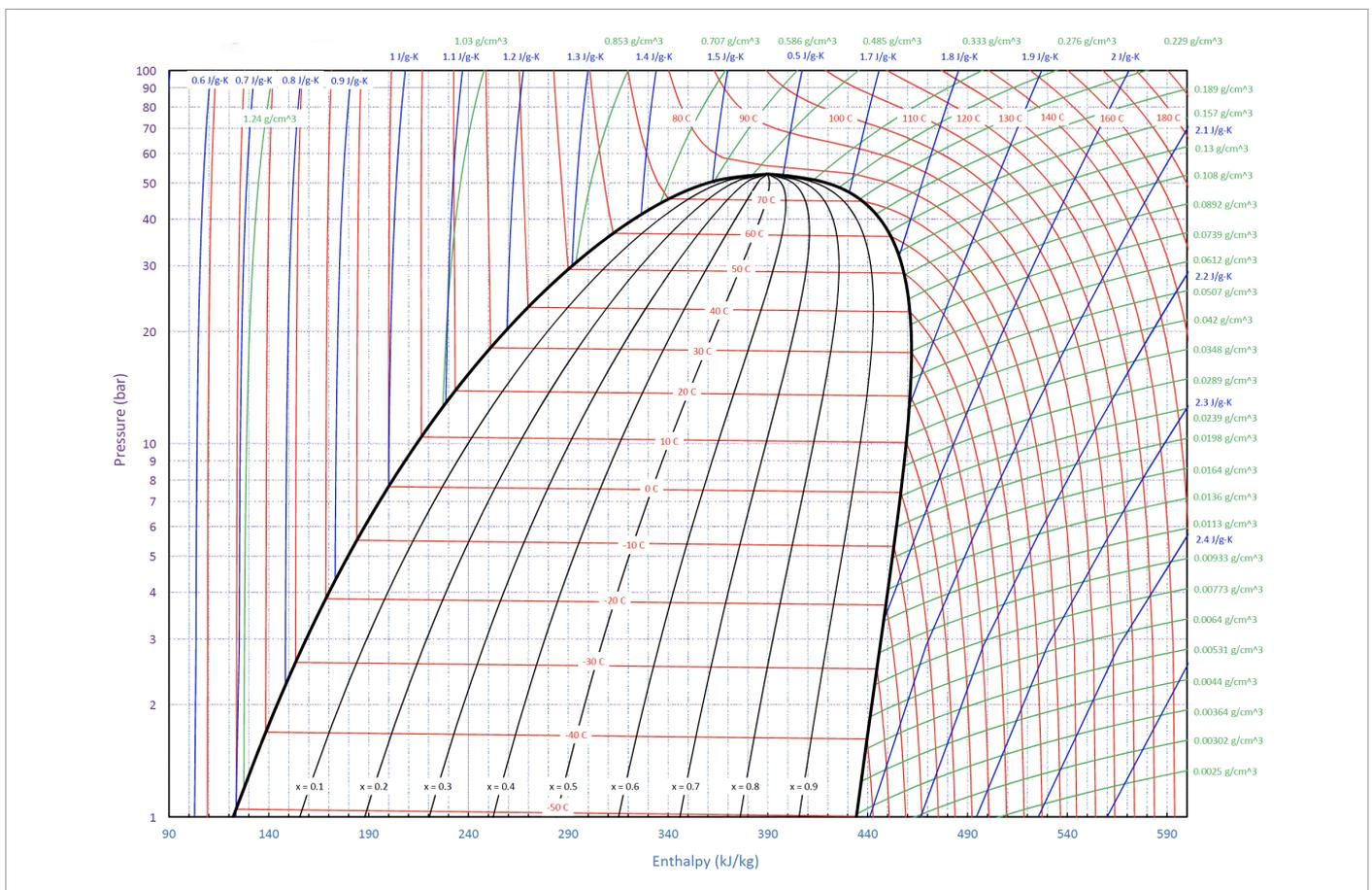
État de référence :  $h = 200 \text{ kJ/kg}$ ,  $s = 1,00 \text{ kJ/kg K}$ ; sat. liq. à  $0^\circ\text{C}$
